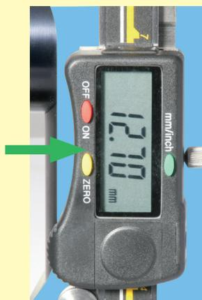
L'instrument de pose des douilles est placé dans la pièce à main en même temps que la douille à mettre en place et le bras de la table de transfert SKY5X est mis à la valeur de réglage et fixé. Maintenant, on peut fixer la douille dans le gabarit de forage. La valeur «profondeur de douille» relevée de la fiche du plan de gabarit (voir l'exemple illustré ci-dessus) est maintenant reportée sur le pied à coulisse et le pied à coulisse est alors fixé.
