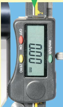
Après le réglage des coordonnées pour un implant, on détermine le plan zéro de la table de transfert SKY5X à l'aide du socle du plan zéro (voir Fig. 1) et du dummy de l'instrument de pose des douilles SKYplanX en le mettant à zéro avec le pied à coulisse.
