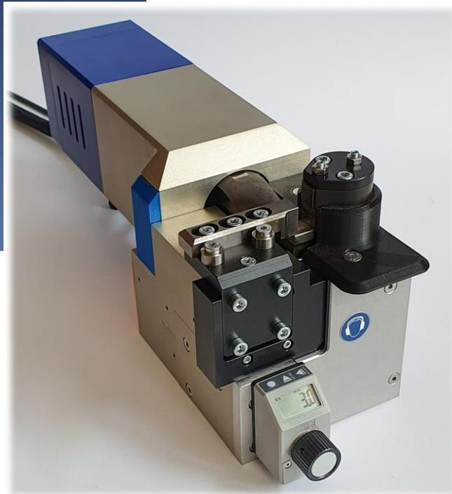
Das Litzenschweißgerät wurde als Einstiegsmodell in das Ultraschallschweißen entwickelt. Es ist für Querschnittsbereiche von 0,5 – 25 mm<sup>2</sup> konzipiert. Durch die Überwachung von Schweißenergie, Zeit und Höhe, sorgt es für eine gleichbleibende Qualität. Einfache Bedienung, schnelle Werkzeugwechsel und geringe Wartungskosten sind Merkmale des LS-3000.
