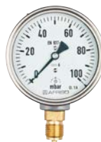
Kapselfeder-Standard- manometer Typ D4, Edel- stahlgehäuse, Ø 100 mm für extrem niedrige Mess- bereiche ab 0/6 mbar
